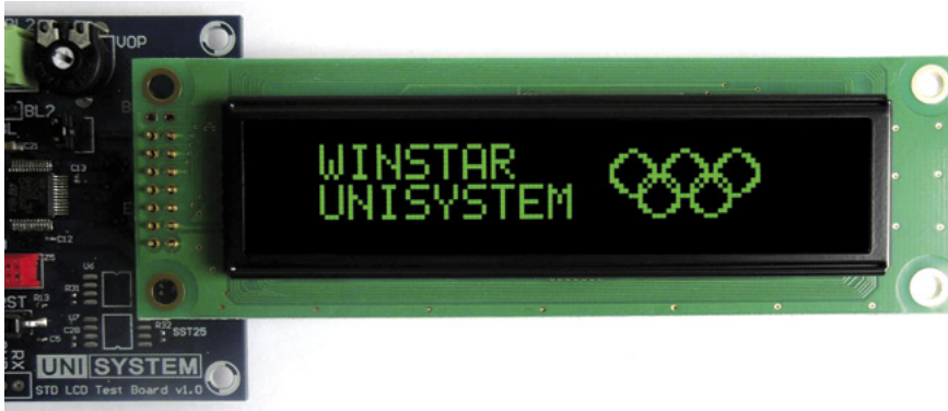
Fotografia 3. Wyświetlacz WEG010016FG pracujący w trybie graficznym
