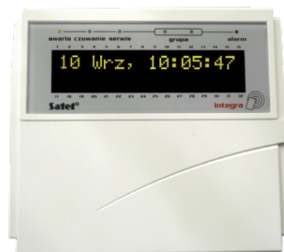
Fotografia 11. Manipulator firmy Satel po wymianie wyświetlacza na OLED
